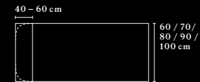
SEITLICHER ANBAU, RECHTECKIG UND GERUNDET LATERAL EXTENSION, RECTANGULAR AND ROUNDED
